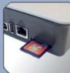
**Speichererweiterung** und Datenübertragung zum PC mit austauschbarer SD-Karte
